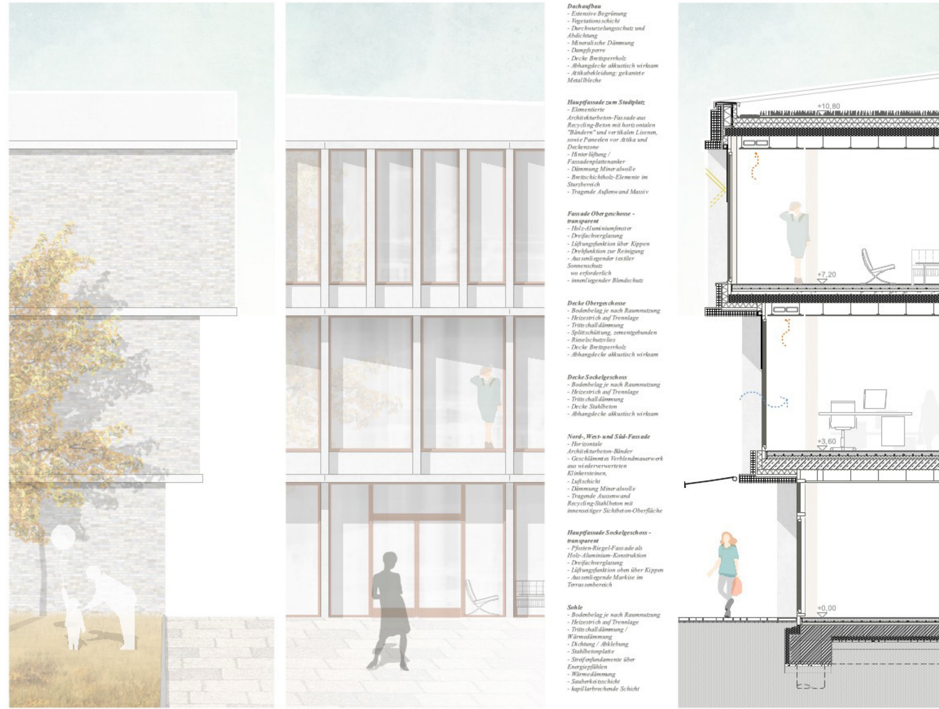
Fassaden-Teilsichten und Fassadenschnitt 1 : 50
